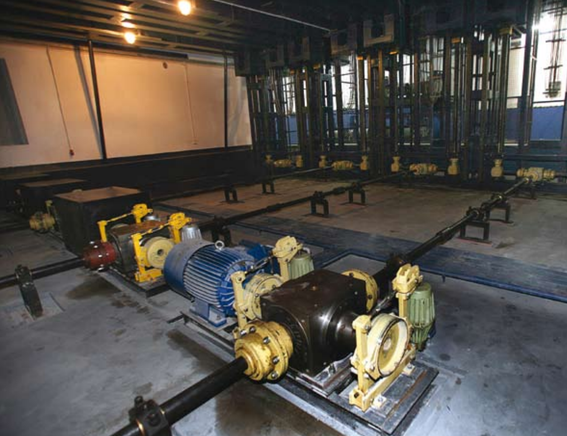
Zdjęcie 32. Zapadnie z napędem śrubowym. Opera Wroclawska. Projekt i wykonanie: Przedsiębiorstwo Specjalistyczne TEATR. 2001
