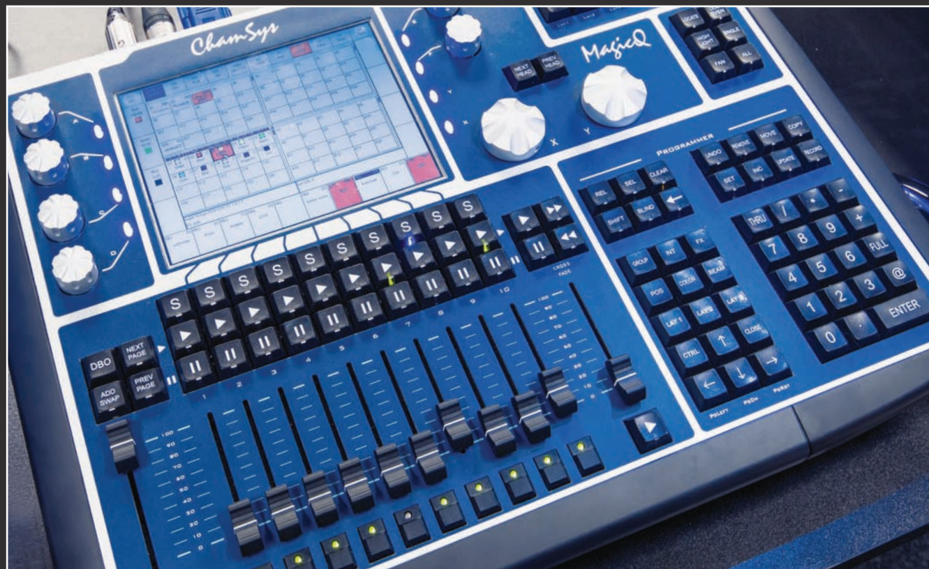
KONSOLETA OŚWIETLIENIOWA MAGICQ MQ60 COMPACT FIRMY CHAMSYS
