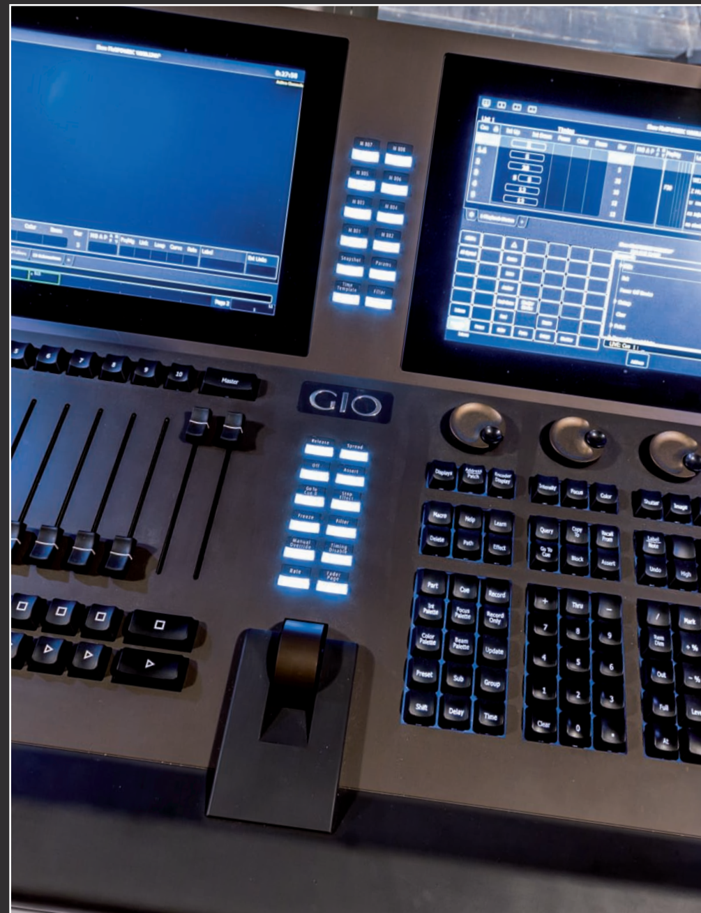
KONSOLETA OŚWIETLIENIOWA GIO FIRMY ETC
